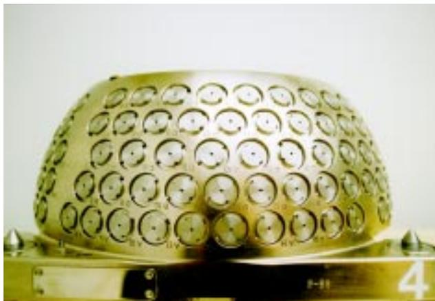
Abbildung 2: Kollimatorhelm mit den insgesamt 201 <sup>60</sup>Co-Quellen. Diese sind so ausgerichtet und ausgeblendet, daß sich die Einzelstrahlen in einem Punkt treffen.
